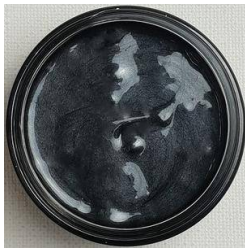
الشكل (11) لاصق حراري ذو قاعدة إيبوكسية مضاف له الجرافيت الأسود
