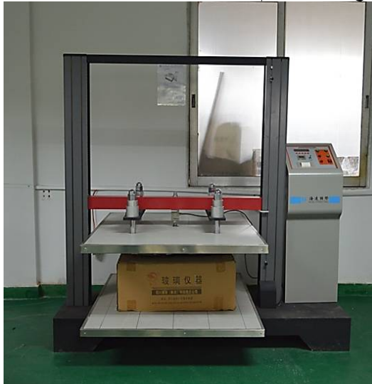
شكل (11) جهاز قياس تحمل الضغط لكلا من الالواح الورقية بنظام خلايا النحل والكرتون المضلع
