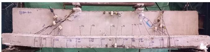
(d) Crack patterns of B<sub>4</sub>
