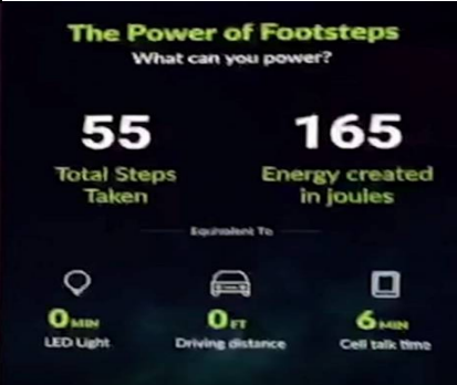
صورة رقم (3) توضح طريقة حساب الطاقة المولدة من الارضيات الذكية
