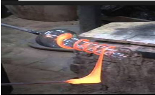
شكل 19 يوضح تشكيل الزجاج بالنفخ
