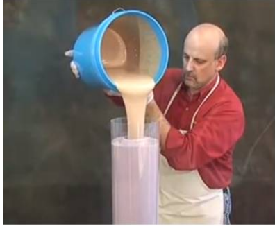
(صورة 18) صب السيليكون داخل القالب رابعاً: بعد جفاف السيليكون نقوم باستخراجه من القالب (صورة 19).
