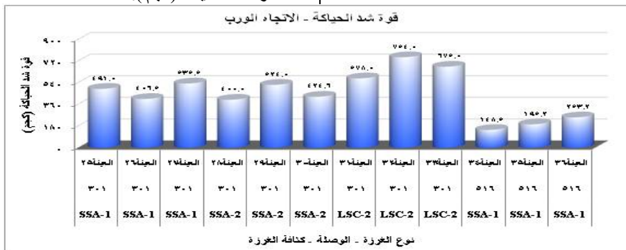
شكل (13): يوضح تأثير كل من (نوع وكثافة الغرز ونوع الوصلة) على خاصية قوة شد الحياكة (كجم).
