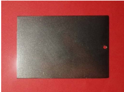
صورة (5) توضح تحول سطح عينة (2) لسطح غير لامع مغطى بطبقة من بولي أميد مركب نانو الفضة و نانو ثاني أكسيد التيتانيوم
