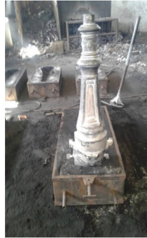
صورة (10) صورة توضح مرحلة من مراحل صناعة أعمدة الإنارة ذات الطرز الباريسية داخل مؤسسة ستيب للستابك الحديدية بصفاقس الغرابية
