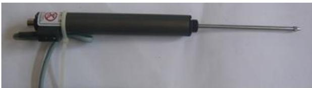
Fig. (16) LVDTs
