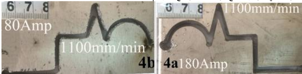
شكل (16) يوضح منظر من الأمام والخلف لعرض مسار القطع للعيينة 4 (أ، ب) عند طاقة 180 أمبير وسرعة قطع 1100 مم/د.
