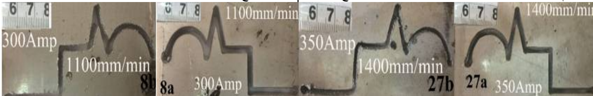
شكل (12) يوضح منظر من الأمام والخلف لعرض مسار القطع للعينات 27، و 8 (أ، ب) عند طاقة 350، و 300 أمبير وسرعات قطع 1400، و 1100 مم/د على التوالي.
