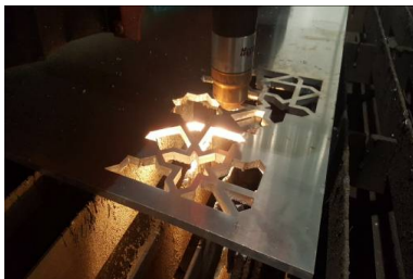
الصورة (9) توضح إجراء عملية قطع الـ AI سمك 10 mm بماكينة البلازما وتتطلب تشطيب
