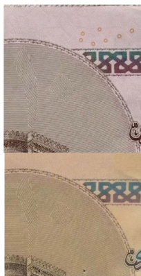
شكل رقم ( ١٧ ) جزء من فئة عشرة جنيهات مصري قبل وبعد اختبار التقادم الضوئي بعد زمن تعريض ٦٠ ساعة
