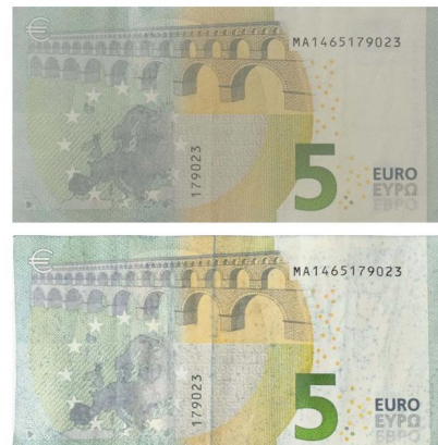
شكل رقم ( ٨ ) ظهر فئة خمسة يورو أوروبي قبل وبعد تجربة مقاومة الزيوت
