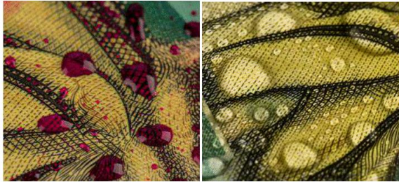
شكل (١) مقاومة الورنيش للرطوبة والزيوت functional-inks. retrieved from,
