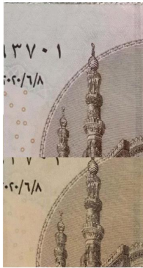
شكل رقم ( ١٦ ) جزء من فئة عشرة جنيهات مصري قبل وبعد اختبار التقادم الضوئي بعد زمن تعريض ٤٠ ساعة
