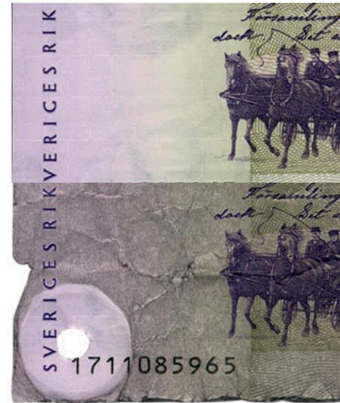
شكل ( ٣ ) دعامة تقليدية قبل وبعد تجربة تداول
