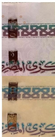
شكل رقم ( ١٨ ) جزء من فئة عشرة جنيهات مصري قبل وبعد اختبار التقادم الضوئي بعد زمن تعريض ٧٢ ساعة
