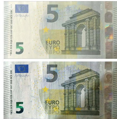
شكل رقم ( ٧ ) وجه فئة خمسة يورو أوروبي قبل وبعد تجربة مقاومة الزيوت
