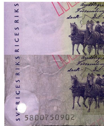
شكل ( ٤ ) دعامة مقاومة للاتساخ قبل وبعد تجربة تداول
