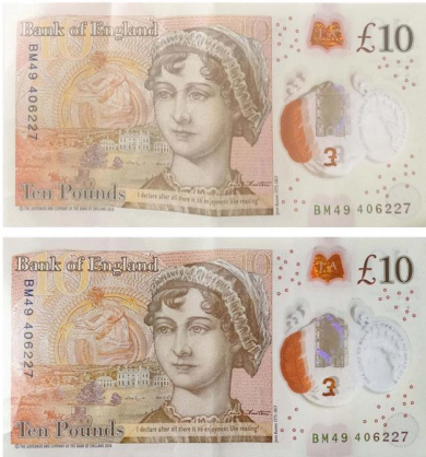
شكل رقم ( ١٠ ) ظهر فئة عشرة جنيهات إسترليني قبل وبعد تجربة مقاومة الزيوت
