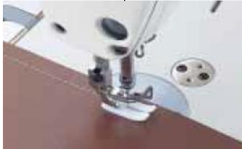
شكل (٦) حياكة الجلد باستخدام Teflon presser foot
