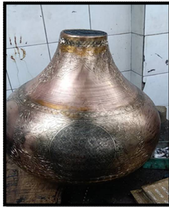
شكل 6: مرحلة العلام (الشنكرة) وذلك برسم التصميم المطلوب باستخدام شوكة العلام بعد نقل التصميم من الورق باستخدام الكربون أو الرسم على المنتج مباشر .
