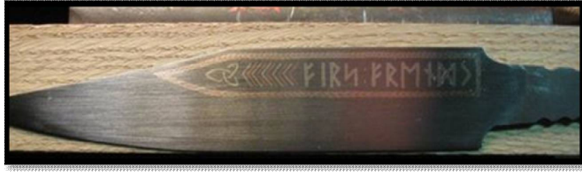
شكل 11: سلاح من الصلب مكفت بالسلك المجدول 6 وكثر حديثاً استخدام التغليف لأسلاك معدنية على خامات أخرى | غير معدنية كالخشب كما هو موضح في شكل (14).
