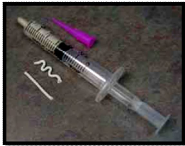
شكل 17: العجينة على شكل سائل في سرنجة لعمل أسلاك (PMC Syringe)
