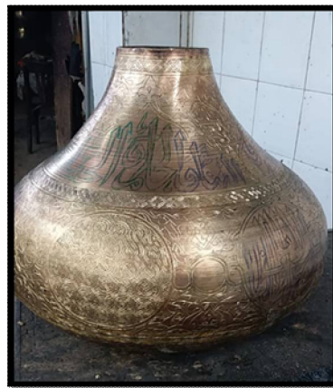
شكل 6: مرحلة العلام (الشنكرة) وذلك برسم التصميم المطلوب باستخدام شوكة العلام بعد نقل التصميم من الورق باستخدام الكربون أو الرسم على المنتج مباشر .
