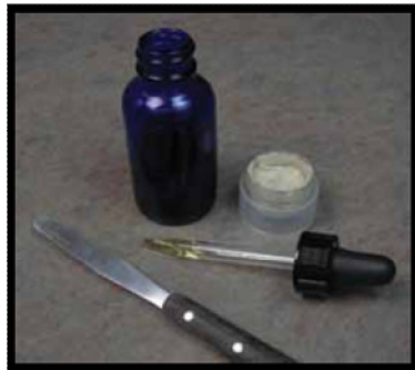
شكل 19: عجينة معدنية بإضافة مواد زيتية تستخدم كطبقة طلاء (oil slip)
