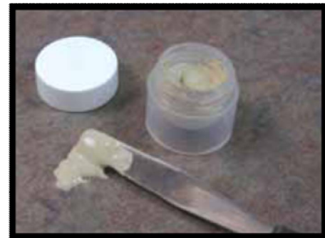
شكل 18: عجينة على شكل معجون (PMC Paste)
