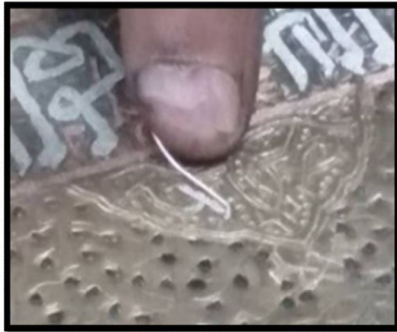
شكل 8: مرحلة تنزيل سلك من الفضة أو الألومنيوم بقطر 0.5 مم بداية من طرفه بالطرق داخل المساحتين الخطيتين
