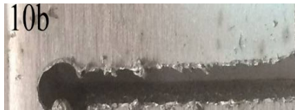
الشكل (6) يوضح منظر مسار القطع من أعلى ومن أسفل للعينة 10 عند قدرة تيار 150 أمبير وسرعة قطع 800م/د.
