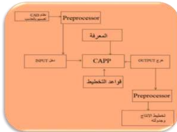
شكل (2) تخطيط العمليات الإنتاجية بمساعدة الحاسب CAPP
