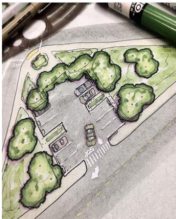
شكل (١٢) يوضح رسمة لموقع عام لموقف للسيارات مع مراعاة استخدام التشجير للظل و لتوفير مناخ بيئي مريح. المصدر (١٤)
